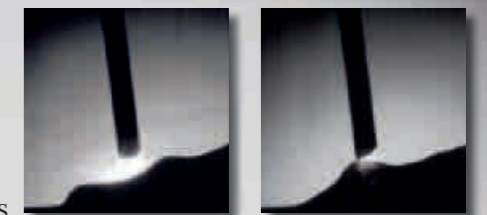
Prise de vue grande vitesse : SpeedRoot en position horizontale
