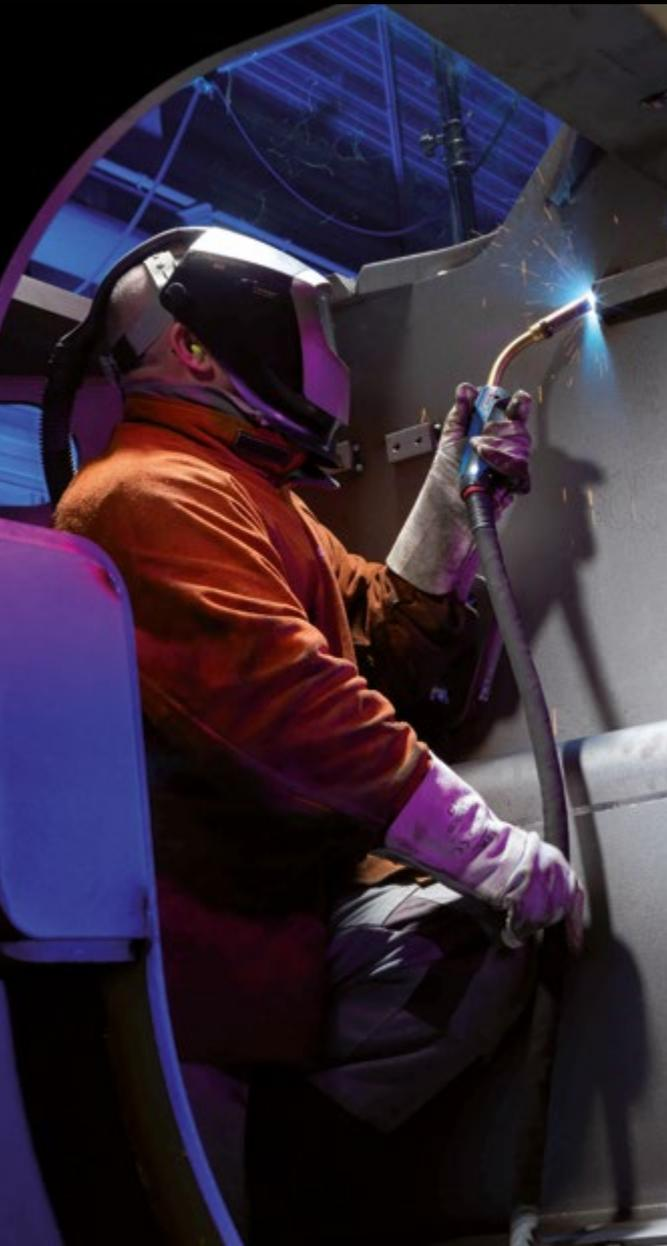
Grâce à une nouvelle conception de la construction de la torche et de nouvelles associations de matériaux, la capacité de refroidissement de la torche MB EVO PRO à refroidissement par liquide a été augmentée de manière significative. La température des pièces d'usure a pu être abaissée de plus de 100°C en comparaison avec des torches concurrentes. Pour un usage intensif dans l'industrie, cela permet d'assurer un arc plus stable et de rallonger sensiblement la durée de vie des pièces d'usure.
