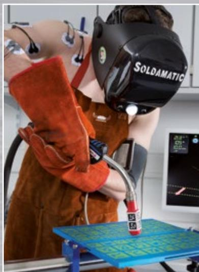
MB EVO PRO 36 en position PA (soudage horizontal de différents joints).
