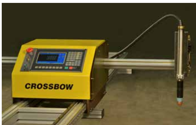
Épaisseur maximale de découpe plasma : jusqu'à 20 mm.
