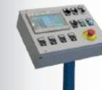
**Boîtier de commande avec fonction apprentissage pour RP 4500**
